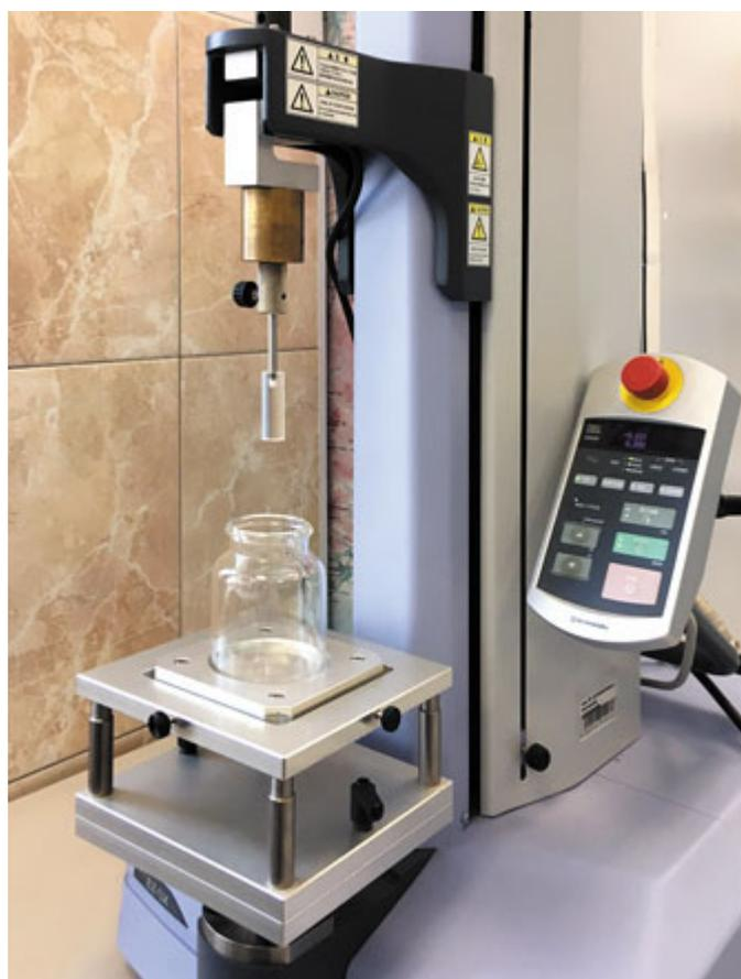
Рисунок 1. Испытательная машина EZ-SX с оснасткой для проведения испытания по ISO 9665
